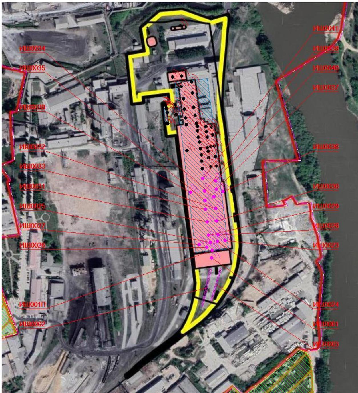
Рисунок 4-2 Расположение источников шумового воздействия (литейно-прокатный цех, авто и жд транспорт)
