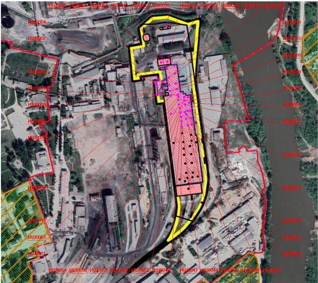
Рисунок 4-1 Расположение источников шумового воздействия (литейно-прокатный цех, компрессорная, открытый склад материалов)
