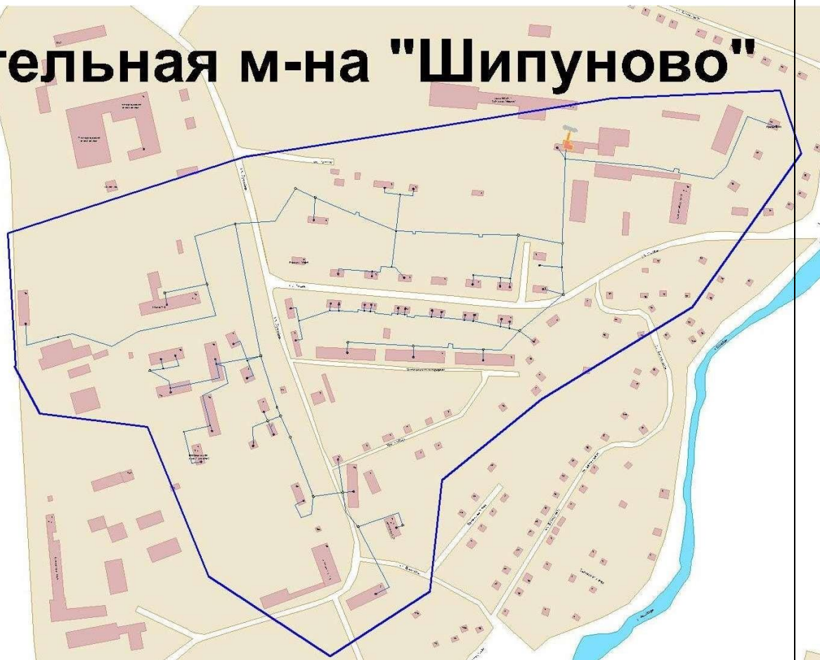
Рисунок 1.6 – Зона действия и схема тепловых сетей Шипуновской котельной ООО «МК Прогресс»
