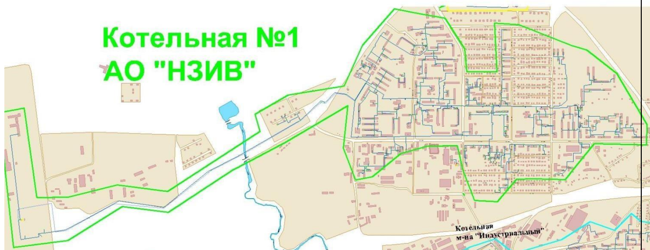
Рисунок 2.10 – Зона действия и схема тепловых сетей котельной №1 АО «НЗИВ»
