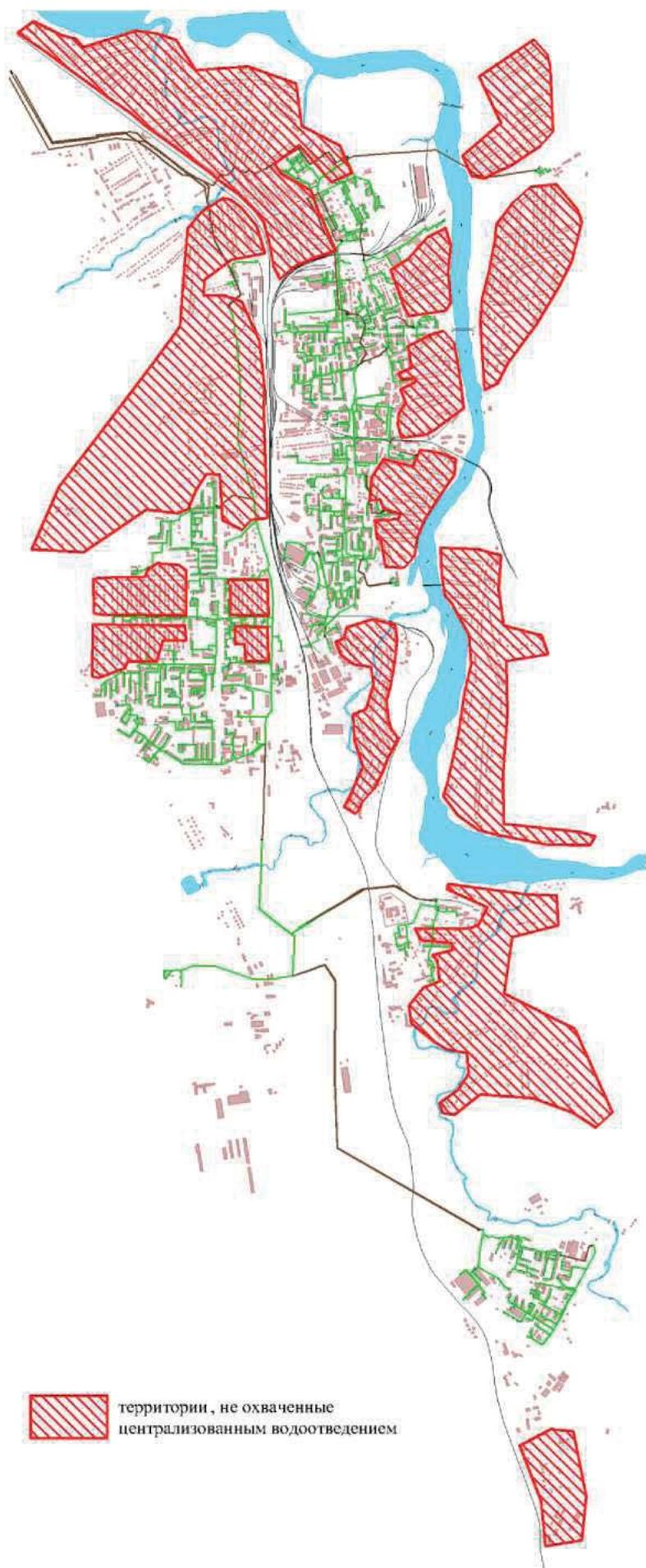
Рисунок 1.2.9-2 Существующая схема водоотведения г. Искитима
