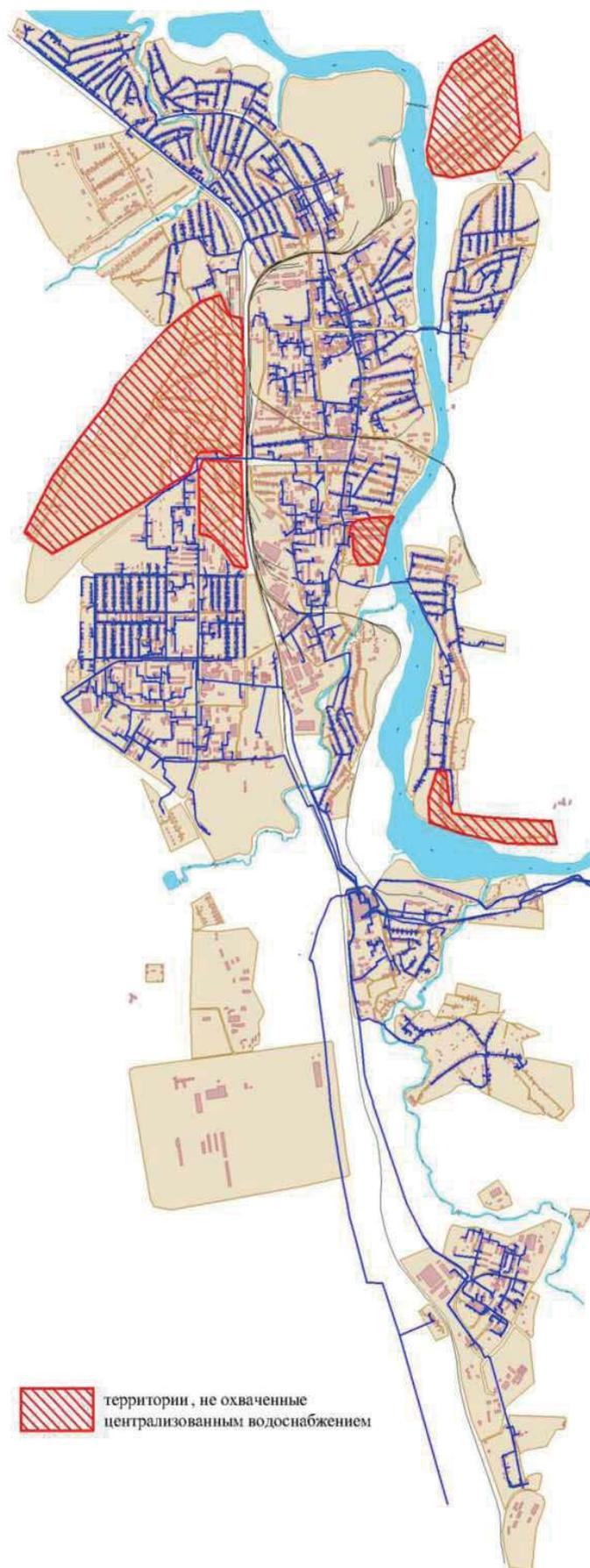
Рисунок 1.2.9-1 Схема водоснабжения г. Искитима
