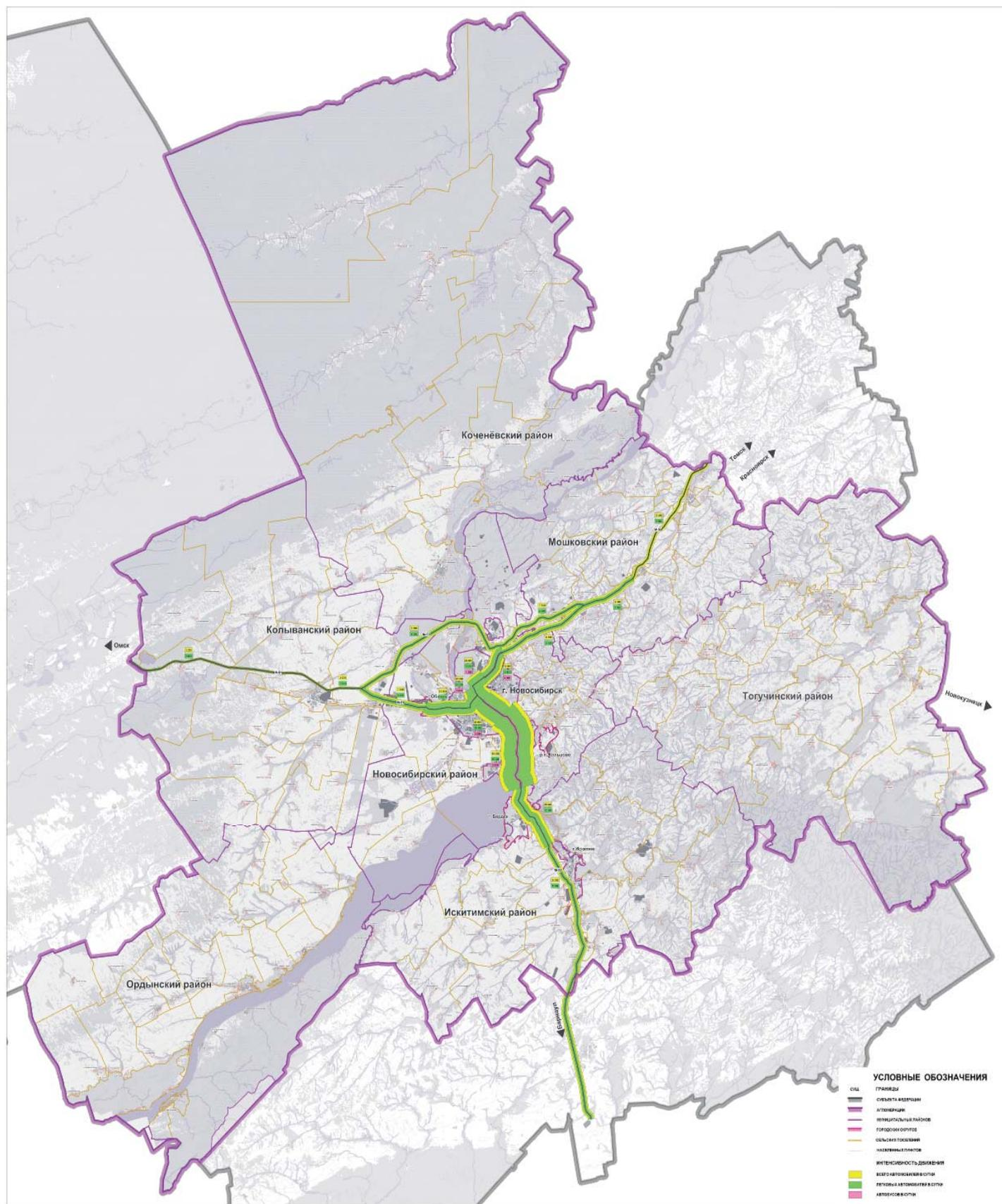
Рисунок 1.2.1-2 Интенсивность транспортного потока по основным магистралям агломерации
